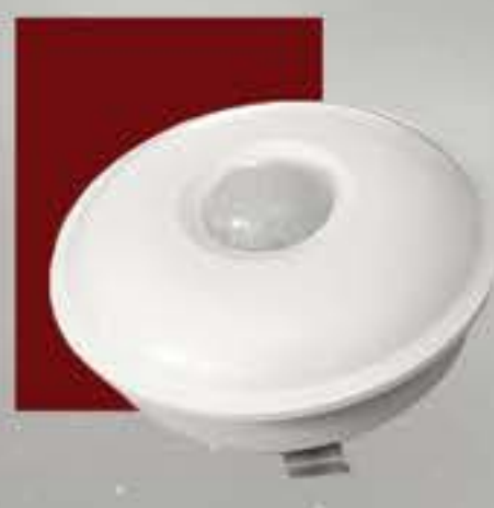
Sensor de Presença de Sobrepôr com Lente de 360° Teto Bivolt - Cód. 5611 •Lâmpada incandescente 127V~ 500W - 220V~ 1000W •Lâmpada fluorescente 127V~160W - 220V~ 320W Sobrepôr e Embutir •Indicado o uso de 2 produtos em corredores longos.
